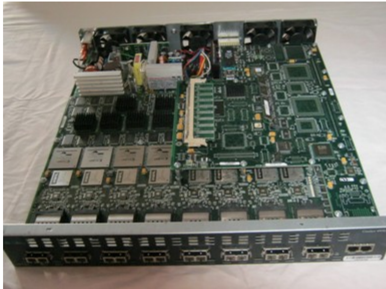
Interno dello switch 4908
